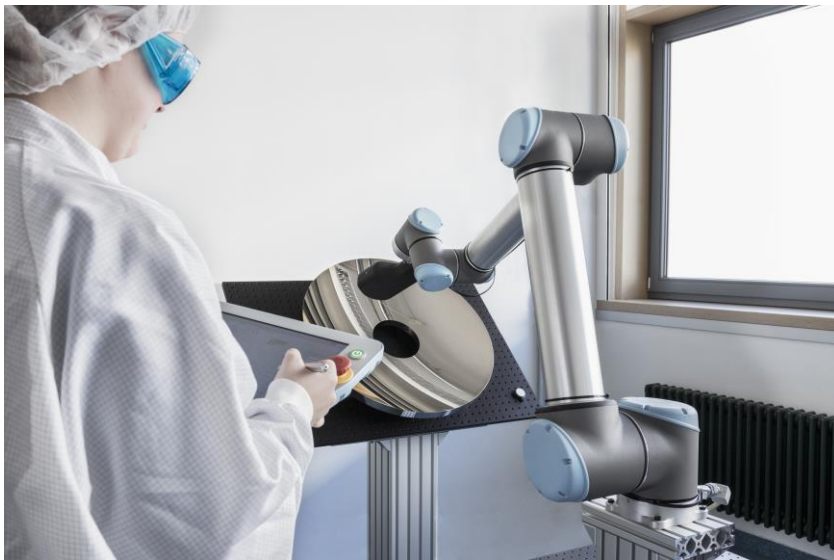
Abb. 2: Roboterassistierte Streulichtmessung zur Oberflächencharakterisierung. © Fraunhofer IOF/WALTER OPPEL
